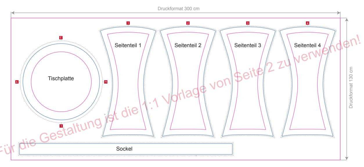
Der Sockel wird an der Stretchhusse unten angenäht und an den Ecken der Tischfüße eingespannt. Bitte den Sockel nur in der gewünschten Hintergrundfarbe anlegen. Keine grafischen Elemente verwenden!
